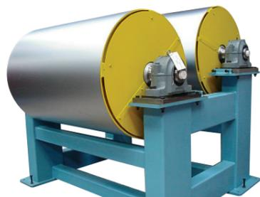
Rouleaux refroidis ø 1100 // Rouleaux refroidis ø 1100
